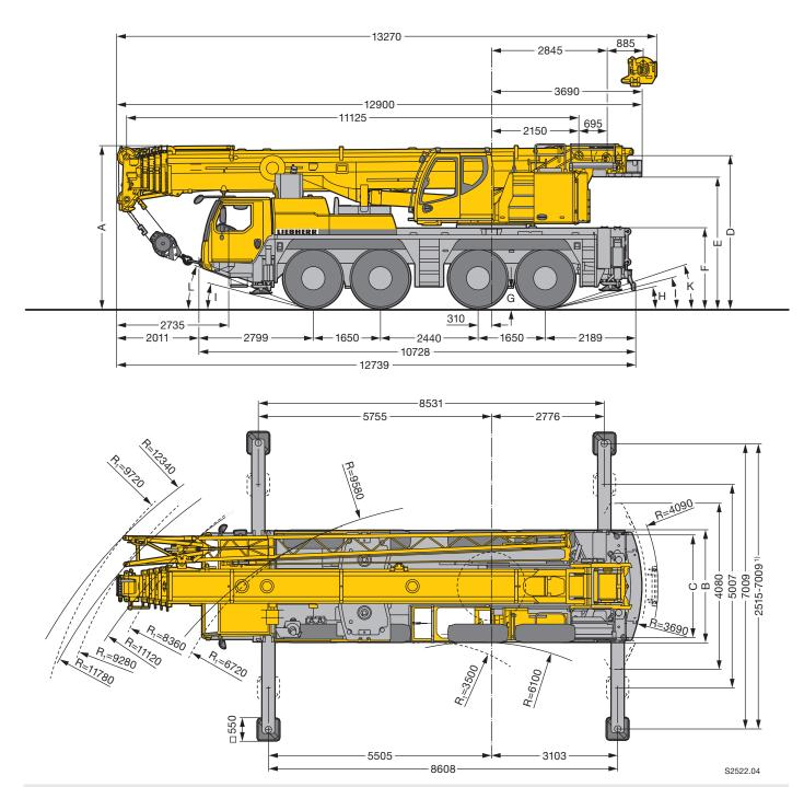
$\textbf{R}_{1} = \textbf{Allradlenkung} \cdot \text{All-wheel steering} \cdot \text{Direction toutes roues} \cdot \text{Tutti gli assi sterzanti} \cdot \text{Dirección en todos los ejes} \cdot \text{Поворот всеми колесами}$ 1) **nur mit VarioBase®** · only with VarioBase® · seulement avec VarioBase® · solo con VarioBase® · sólo con VarioBase® · только с VarioBase®
